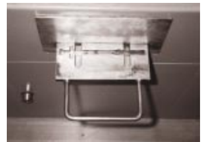
On insère une seringue usagée dans le distributeur et l'on obtient une seringue stérile (prison de Saxerriet, Suisse).
